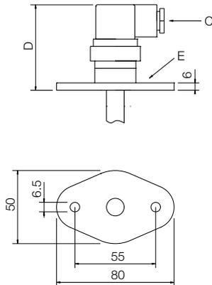
**Conexión a proceso por brida ovalada con conector DIN 43650 de PA (3 pines), DIN VDE 0627 (6 pines)**
