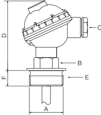
**Cabezal de PP con tapa roscada**
