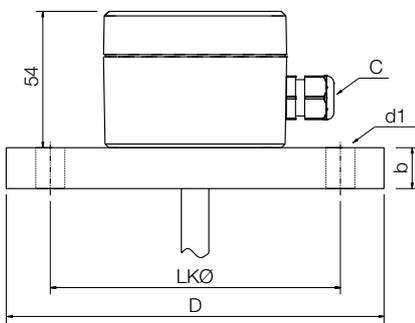
**Conexión a proceso bridada según DIN EN1092-1 PN16/ANSI B 16.5 150 lbs con carcasa de aluminio**
