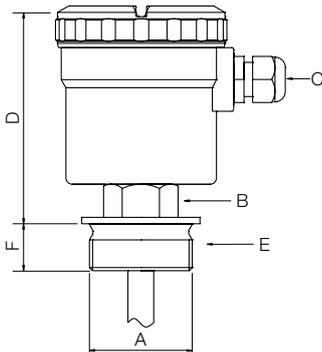
**Cabezal de PA con tapa roscada**
