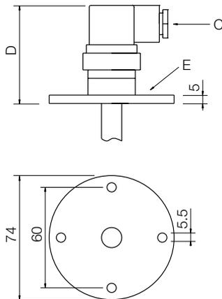
**Conexión a proceso por brida circular con conector DIN 43650 en PA (3 pines), DIN VDE 0627 (6 pines)**
