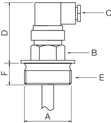
**Conexión a proceso roscada con conector DIN 43650 de PA (3 pines), DIN VDE 0627 (6 pines)**
